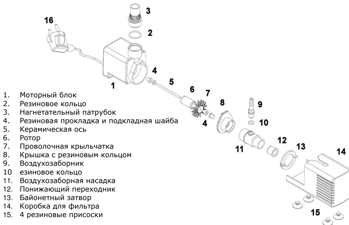
Рис. 2: Устройство диспрегаторной помпы AQ 1200 с проволочной крыльчаткой
